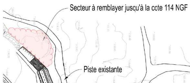
**Fermeture à l'amont du coursier béton – Remblaiement en rive gauche**
